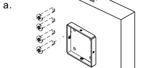
壁面にボルト・ネジで固定してください。壁面に取り付けるボルト・ネジは付属されていません。壁の状態に合わせてご準備ください。
